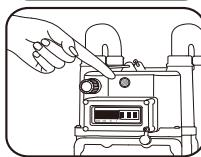
4 約3分待つ。この間にマイコンが安全を確認。赤ランプの点滅が消えるとガスが使えます。
