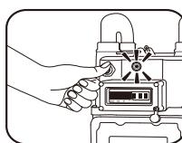
3 復帰ボタンを奥まで押し、すぐ手を離す。ボタンは元に戻り、赤ランプが再び点滅したらキャップを元に戻す。
