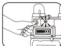
3 復帰ボタンを奥まで押し、すぐ手を離す。ボタンは元に戻り、赤ランプが再び点滅したらキャップを元に戻す。
