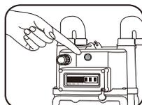
4 約3分待つ。この間にマイコンが安全を確認。赤ランプの点滅が消えるとガスが使えます。
