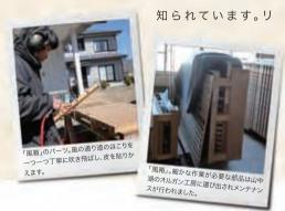
ニューアルオープンの9月までにモダン側の手鍵 盤や回転盤のメンテナンス・調整を終え、9月から は足鍵盤とバロック側の全てのパイプの清掃・メ ンテナンスに入りました。開館から20年の汚れと 改修工事によるほこりをすべて取り除き、重力に より歪んだパイプを綺麗に補整していきます。一 度パイプを切断しハンダで繋ぎ合わせたり、木の 型を使ったりと状態によって補整の方法は様々。 中でも低音を担当する足鍵盤のパイプは大きい 物で12mにもなり、改修工事中は作業の難しい 場所のひとつでした。改修後の作業時間は夜22 時から朝8時。作業人数は2名から4名のオルガ
